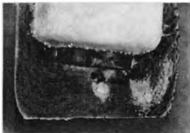
Р и с. 5. Застывший скол проплавленного силикатного стекла
