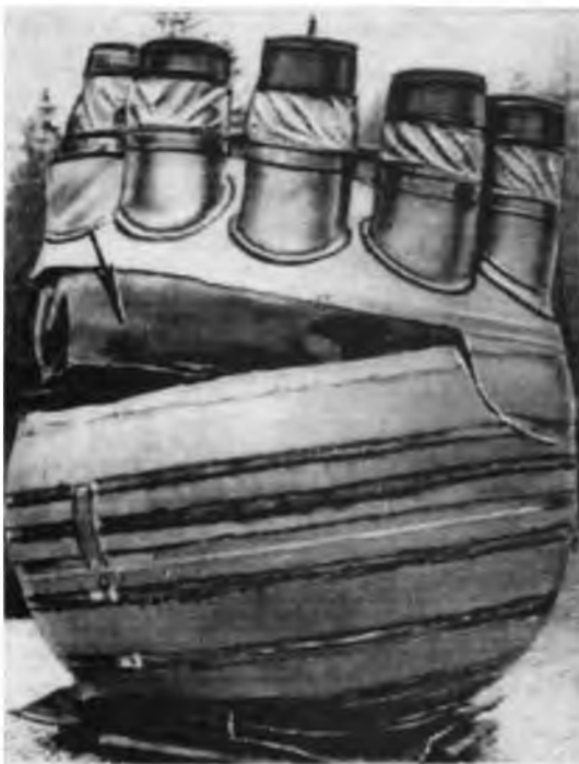
Р и с. 5. То же, что на рис. 3, после опыта № 10 (стрелкой показан деформированный взрывами имитатор теплового экрана, видимый в раскрытой трещине в зоне связи крыши с горловиной)
