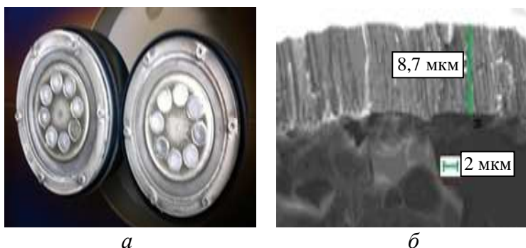
Р и с. 1. Нанесение хромоалюминиевых покрытий на циркониевую оболочку твэла: а — мозаичная мишень из алюминия, укомплектованная штифтами из хрома; б — микроструктура однослойного покрытия
