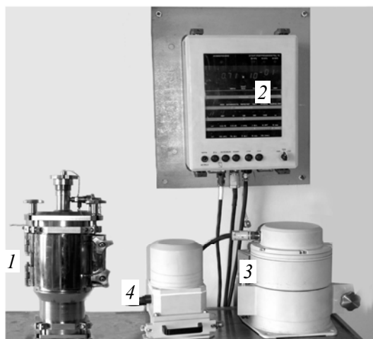
Р и с. 2. Блок выделения радионуклидов БХ-138С (1) в составе радиометра РКС-02С, измерительный пульт УИ-111С (2), блок \beta -БДИБ-04С (3) и \alpha -детектирования БДИА-03С (4)
